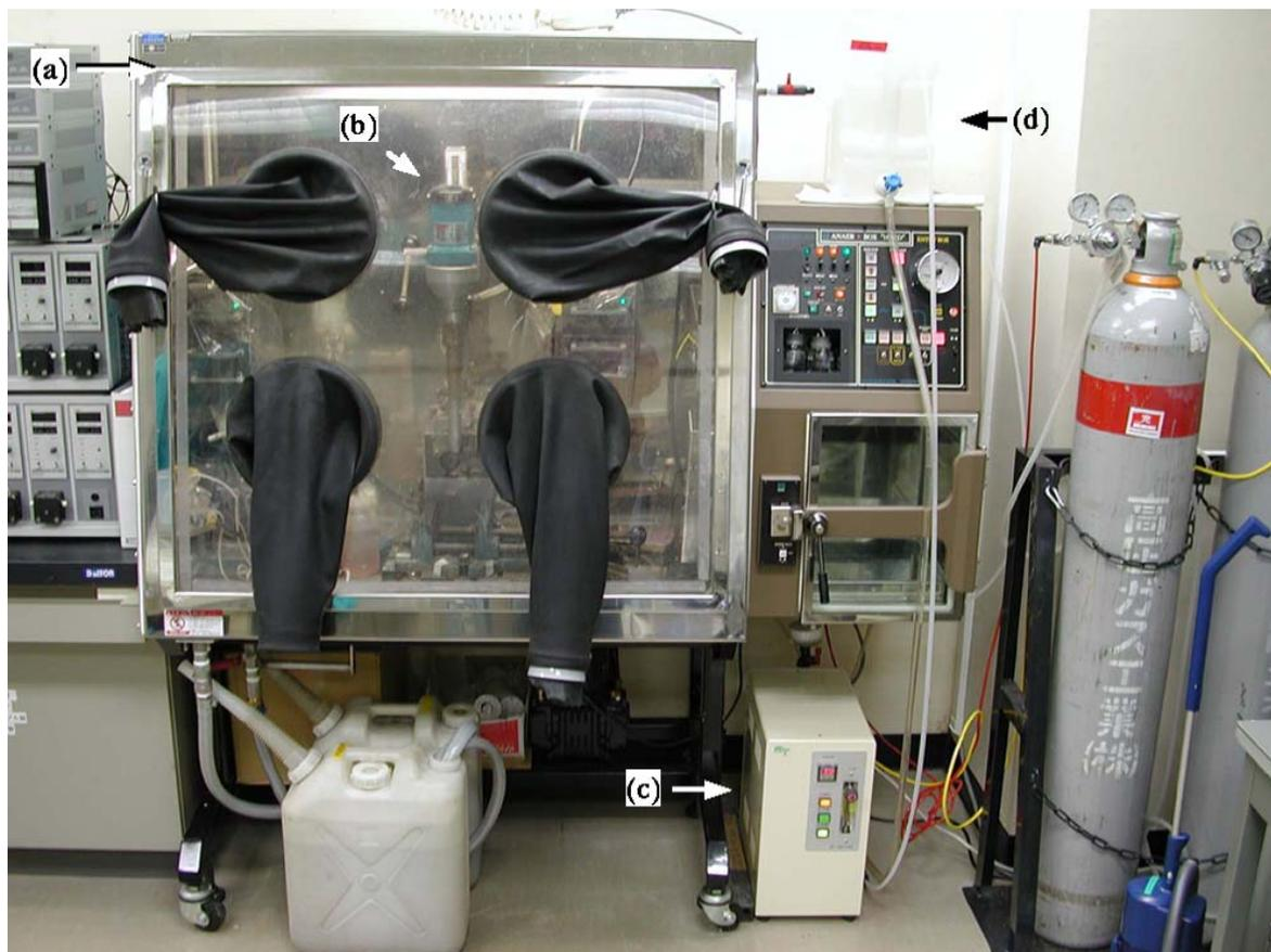
サブコアリング装置。ボーリングによって回収された岩石コアサンプルのうち、掘削水による汚染が起こっていないと考えられる内側部分のみを嫌氣的・無菌的にサブコアリングすることができる。サブサンプリングをおこなう岩石を、ドリル本体 (b) 底部に万力にて固定し、給水タンク (d) から水を導入しながら岩石コア中心部をくり抜いていく。サブコアリング (コア前処理) 作業はすべてグローブボックスの中で嫌氣的条件下でおこなうことができる。グローブボックス内は、 $N_2$  ガスおよび  $N_2$  (80%) +  $H_2$  (10%) +  $CO_2$  (10%) の混合ガスで置換されており、内部の酸素濃度は 0% である。給水タンクの水は、ドリルによって生じる熱の冷却およびドリルビットの消耗防止のためである。給水タンク内の水は、あらかじめオートクレーブ滅菌およびフィルター濾過滅菌 (孔径 0.22 mm) をおこなっており、脱気装置を通すことで溶液内の酸素濃度を 0.5 ppm まで下げることができる。冷却用に使用した水は、グローブボックス下部から排水できるようになっている。
