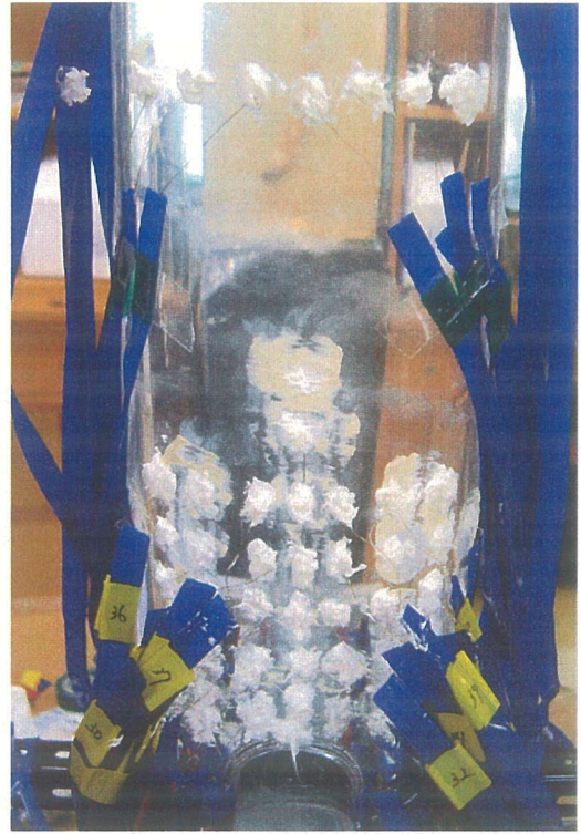
Fig.2.17 熱電対設置外觀
