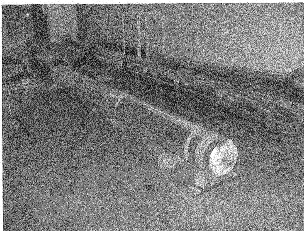
写真4 2重目養生後の気密容器
