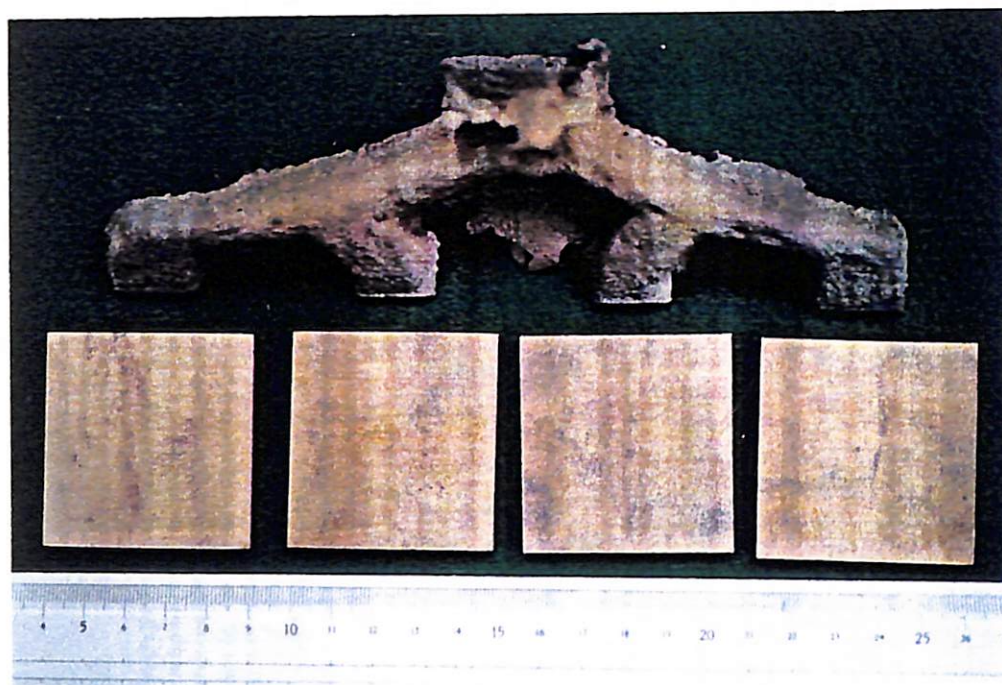
写真1 青銅（発掘品模擬合金）試料外観写真
