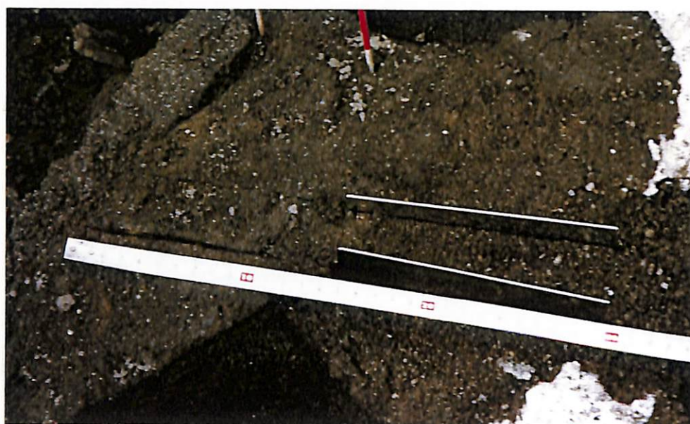
写真25 不攪乱試料採取状況(1)
