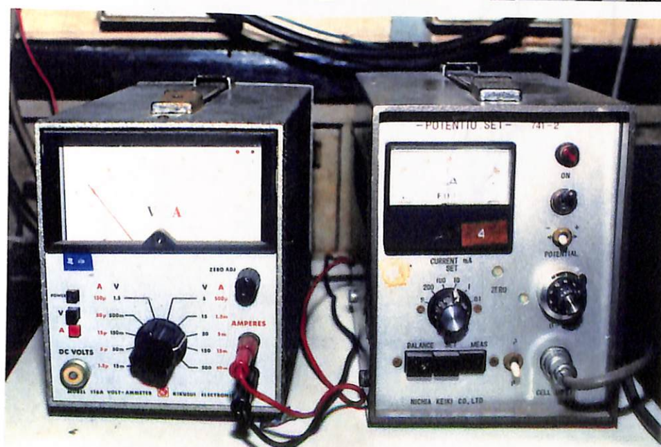
写真2.2.2-4 電気化学試験状況-4 (定電位下の腐食試験-2)
