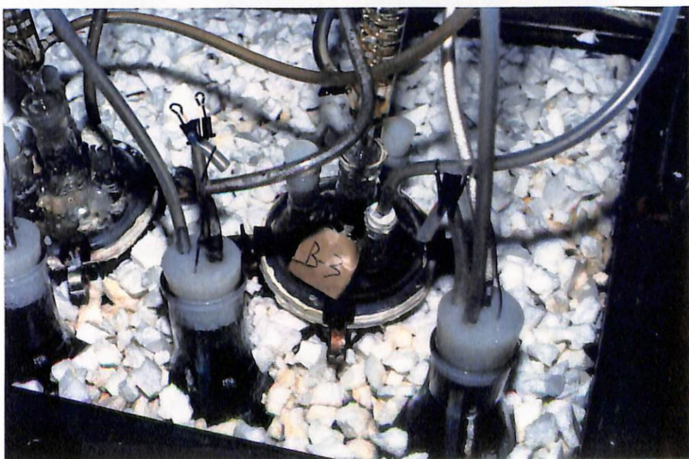
写真2.1.2-2 浸漬腐食試験状況-2
