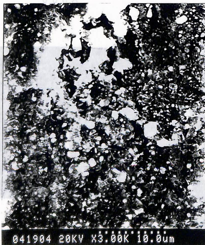
写真 2.2.2.-7 自然浸漬電位測定試験片表面のSEM/EDS (人工海水/単純浸漬、310時間)
