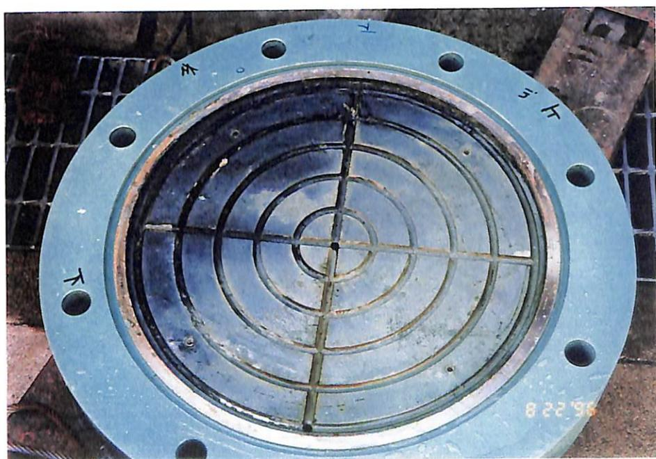
図-2.14 透水試験装置（2）
