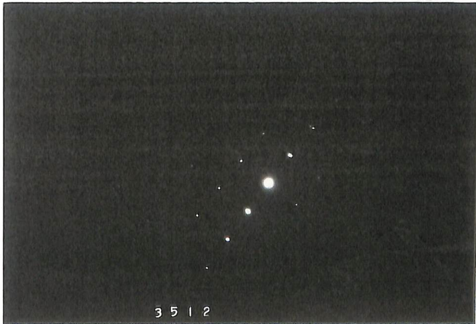
図 2 - 3. 1 - 10 試料 B におけるモンロライト以外の鉍物の電子線回折像
