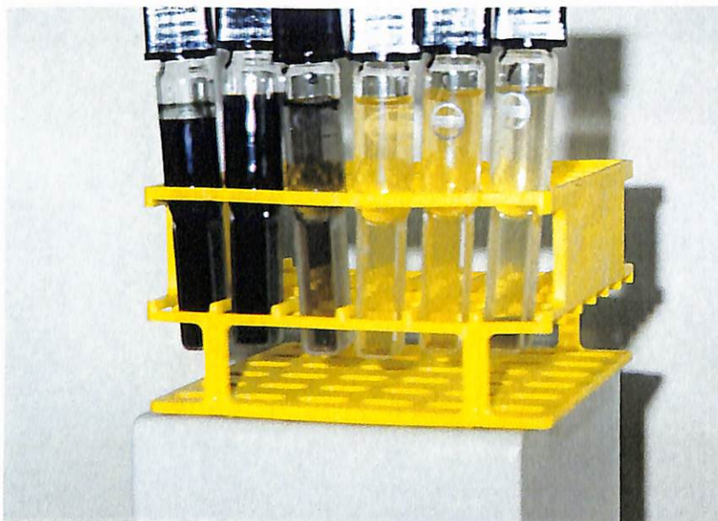
写真3.2-1 試験中の特製光度計セル付き嫌気性培養試験管
