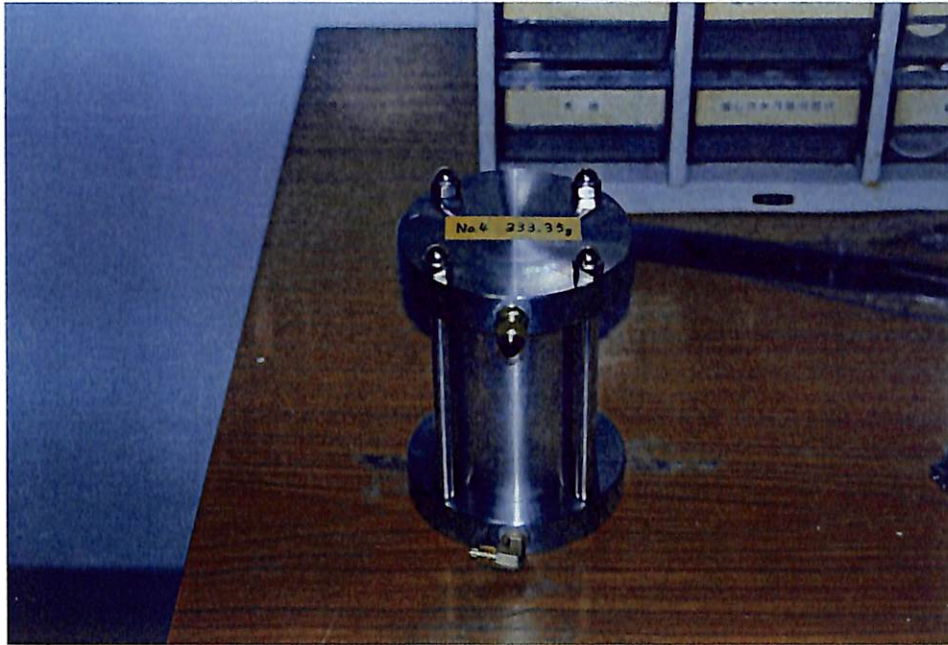
写真 5.1.4 - 11 「切断-接合・飽和- \overline{CU} 」用供試体の飽和セルへの設置状況（その2）
