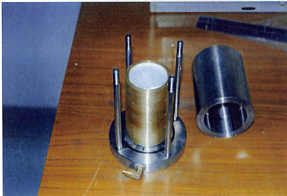
写真 5.1.4 - 11 「切断-接合・飽和-CU」用供試体の飽和セルへの設置状況（その1）
