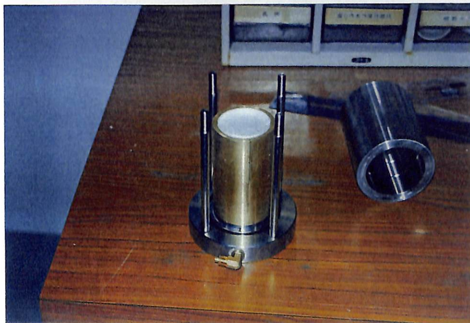
写真 5.1.4 - 10 「飽和 - \overline{\text{CU}} 」用供試体の飽和セルへの設置状況 (その1)
