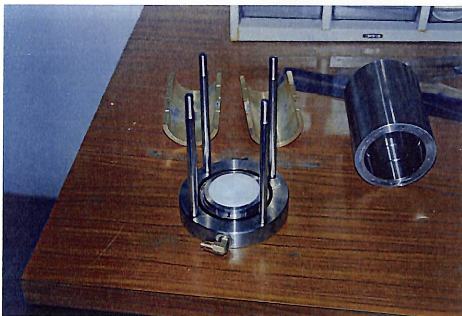
①下部加圧盤に テフロン製フイ ルターを設置
