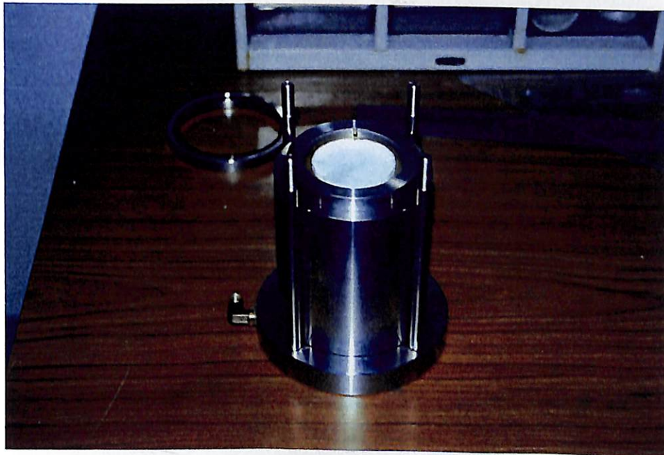
⑤上部内筒を設置
