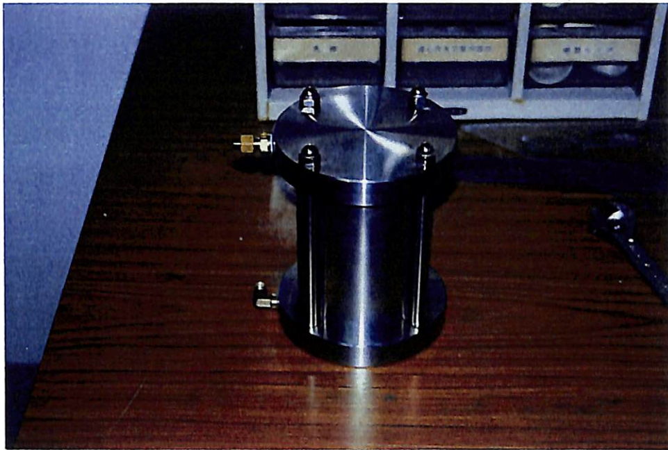
写真 5.1.4 - 12 「飽和一切断-接合・注水-CU」用供試体の飽和セルへの設置状況 (その3)
