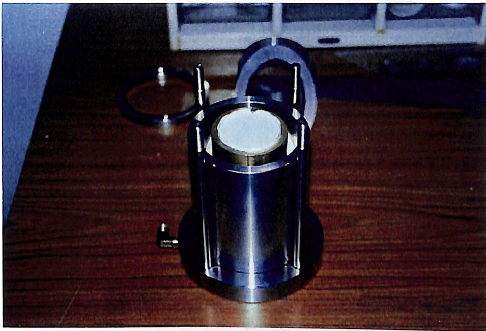
④上部モールドを設置
