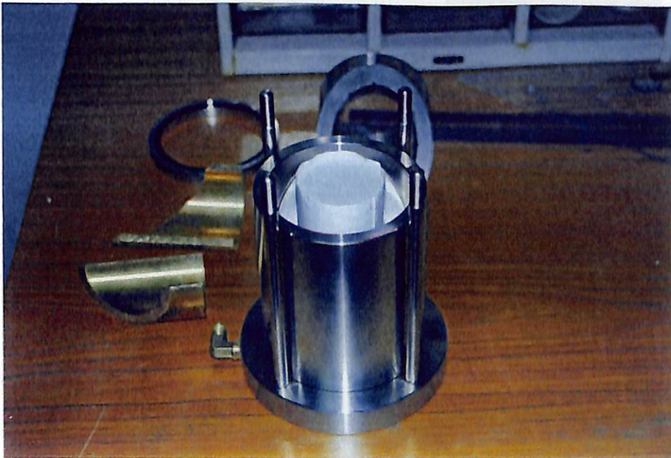
写真 5.1.4 - 12 「飽和一切断-接合・注水 - \overline{CU} 」用供試体の飽和セルへの設置状況 (その1)
