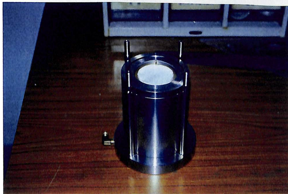
写真 5.1.4 - 12 「飽和一切断-接合・注水- \overline{CU} 」用供試体の飽和セルへの設置状況 (その2)
