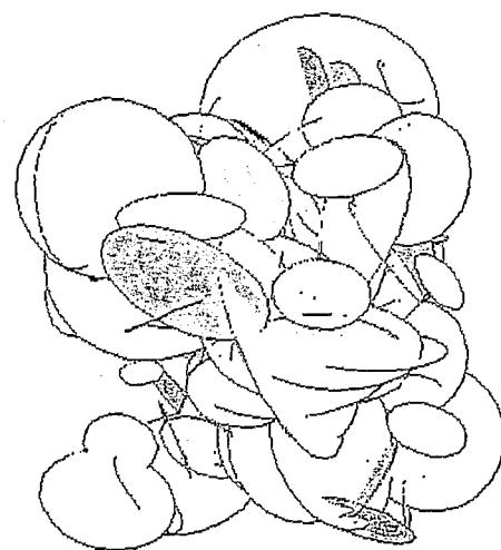
図-3.1.2 亀裂ネットワークモデル
