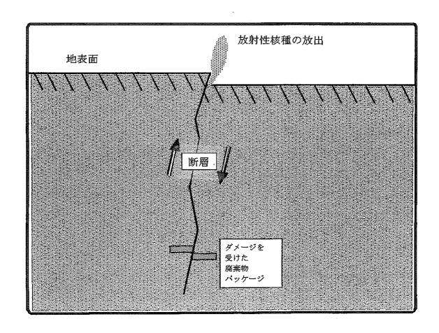
図1 仮想的な活断層シナリオを示す概念図 (縮尺は無視している。廃棄物パッケージの実際の設置深度は 数百メートルである)
