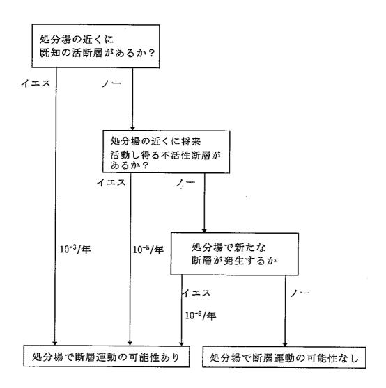
図2 HLW地層処分場で断層運動が起こり得る条件を示す論理図
