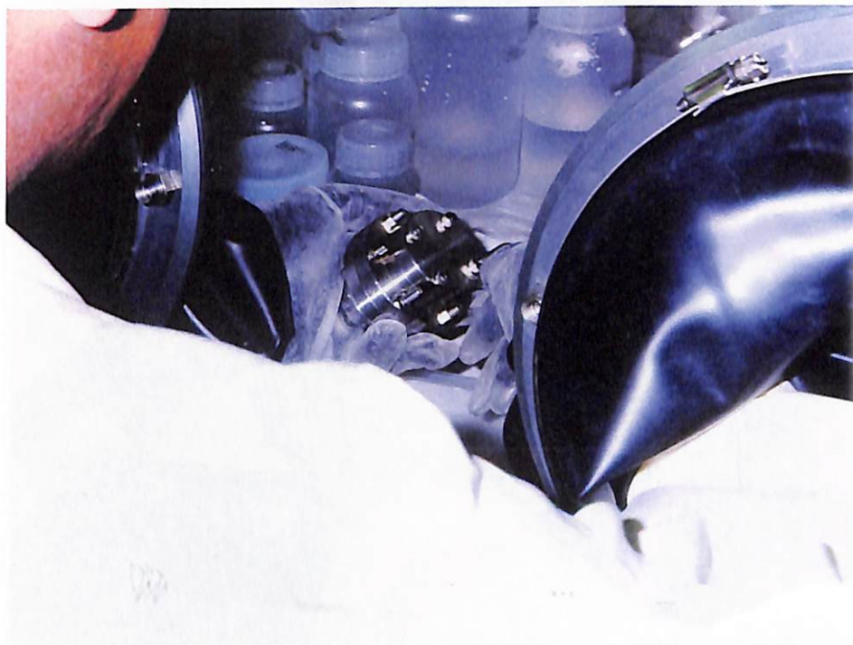
写真3-5 カラムへのSn塗布 操作④
