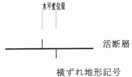
図-2 水平変位量の計測
