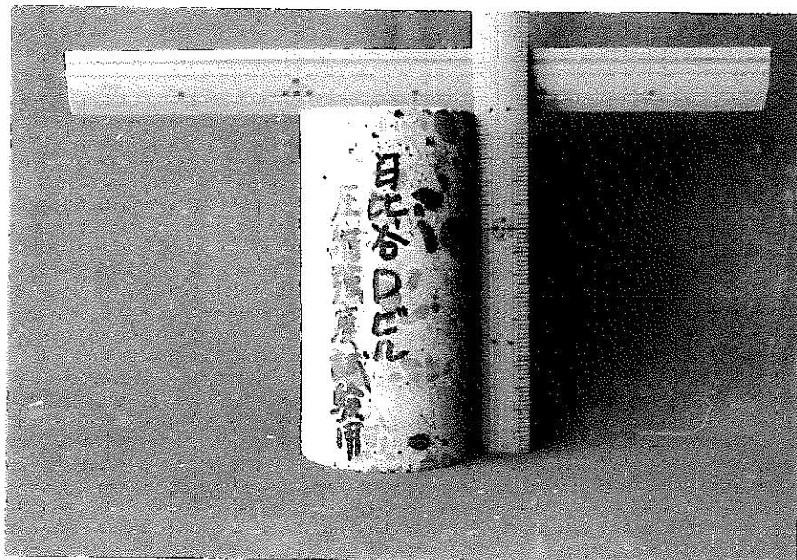
写真 3.2-1 Dビル圧縮強度試験用供試体
