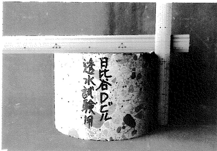
写真3.2-4 Dビル透水試験用供試体
