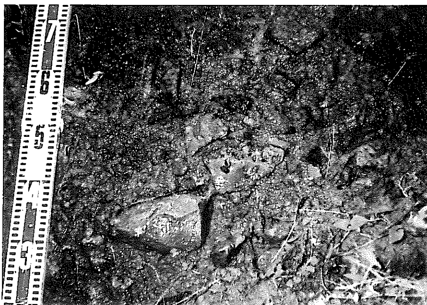
写真 9 2 シルト岩の礫を伴う沼層 シルト岩の礫には穿孔貝による穿孔痕が認められる。
