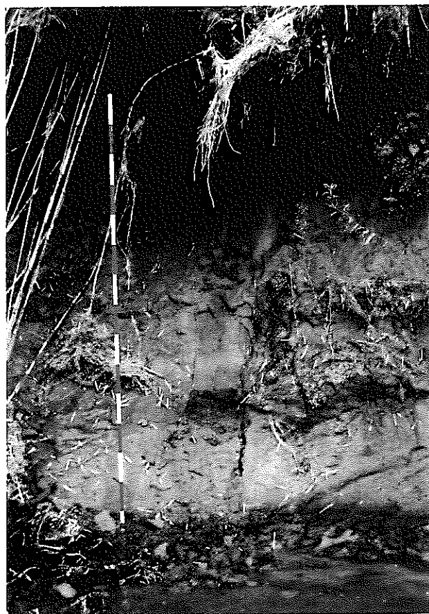
写真 1 1 4 N-6, 7の試料採取 層準 沼層のシルト層と挟在する泥炭 層。泥炭層からN-6を、シルト層 からN-7を微化石試料とFeS 2 分析 用試料として採取した。
