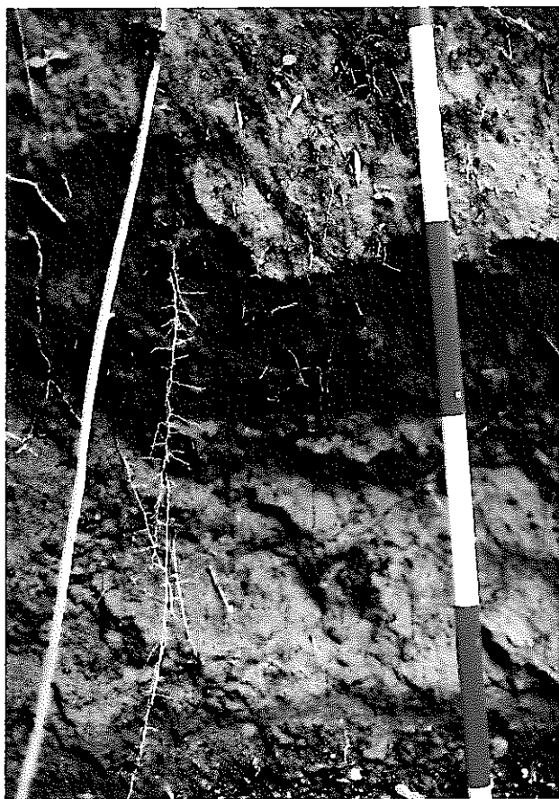
写真120 N-17の試料採取層準 沼層を不整合に覆う沼Ⅲ面段丘堆 積層上部のシルト層を、微化石試 料と \text{FeS}_2 分析用試料として採取した。
