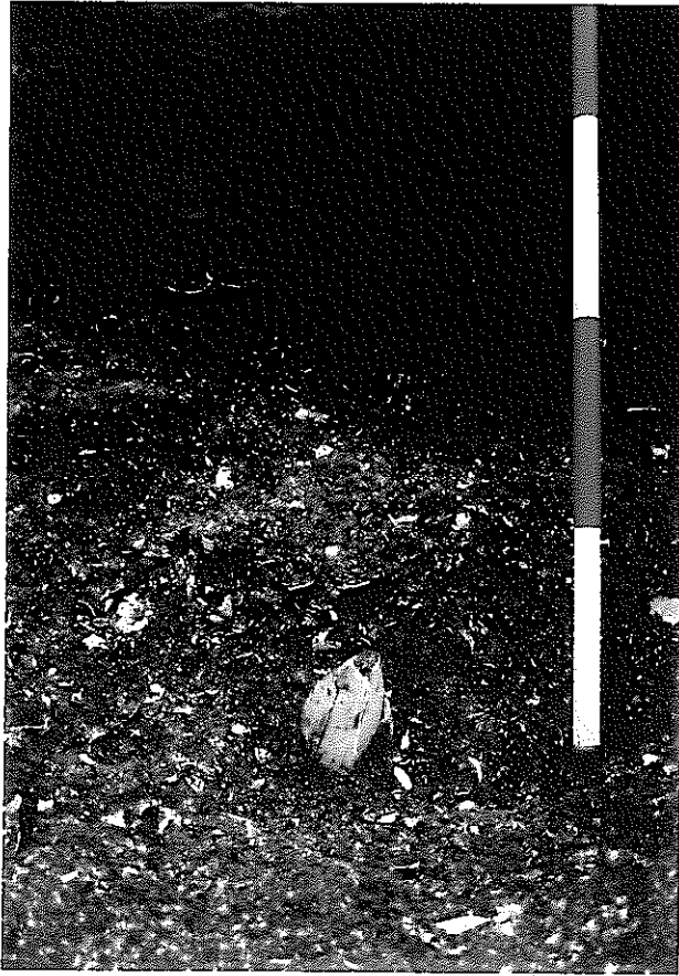
写真105 KH-3の試料採取層準 KH-2のやや上位に位置する。木下 層下部の中～粗粒砂からなる貝化 石床から、自生の貝化石 Tresus keenae (写真中央) をESR年代 測定用試料とTL年代測定用試料 として採取した。
