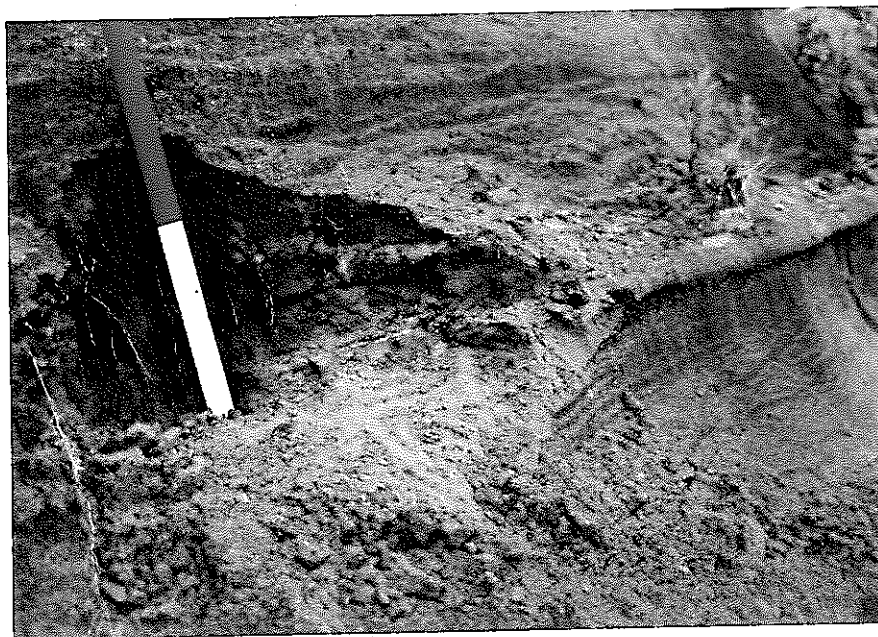
写真109 KH-7の試料採取層準 木下層中部の生痕化石を伴う細～中粒砂中に挟在するシルト～細粒砂を微化石試料として採取した。
