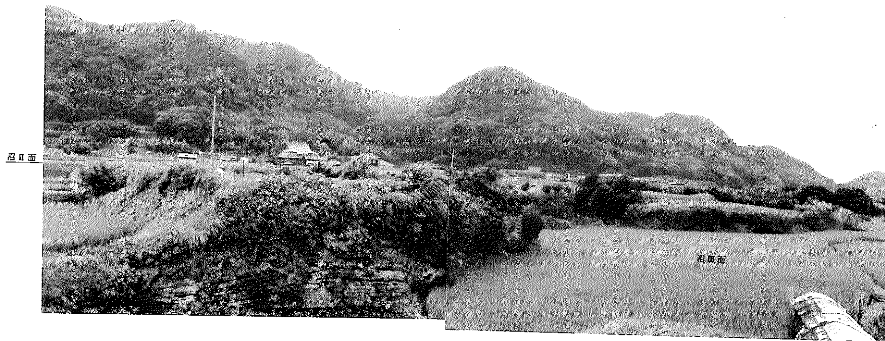
写真 6 6 千倉町千田ー平磯付近の沼Ⅱ面と沼Ⅲ面 (Pgs. 23 地点) 沼Ⅱ面と沼Ⅲ面は比高 2~3m の段丘崖で接する。沼Ⅱ面は第三系の堆積岩類が侵食されてできた平坦面である。
