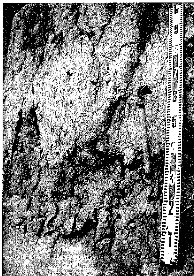
写真36 市原Ⅱ段丘堆積層を 覆う新期関東ローム層 市原Ⅱ段丘堆積層の最上部は暗 褐色の砂礫混じり粘土からなる。 それを整合に覆う新期関東ロー ム層は黄褐色シルト質火山灰か らなり，径1～2mmの黄褐～橙色 軽石(Hk-TP)を挟む。
