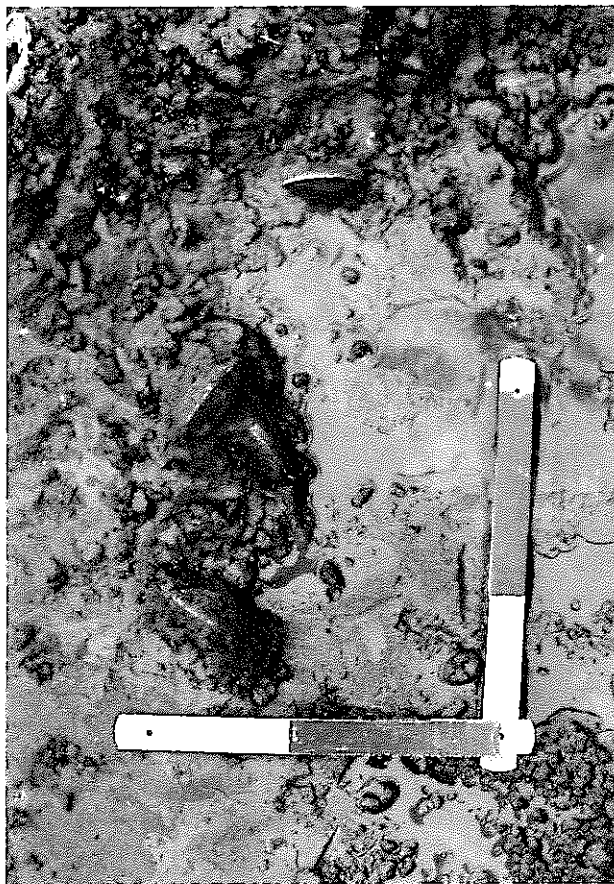
写真119 N-16の試料採取層準 沼層上部の貝化石を伴う砂質シル ト層中の自生の貝化石 Dosinella peniciata を、 ^{14}\text{C} 年代測定用試料、 ESR年代測定用試料として採取 した。また、同一層準から微化石 試料、貝化石試料および \text{FeS}_2 分析 用試料をそれぞれ採取した。
