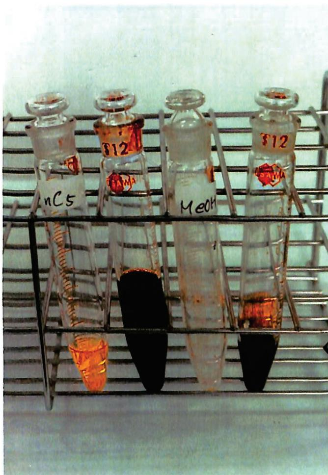
写真3-2 シリカゲルカラムクロマトグラフィーにより分画されたアスファルトの各分画。左よりn-ペンタン分画、ベンゼン分画、メタノール分画、アスファルテン分画。すべて溶剤で125mg/mlの濃度に合わせてある。
