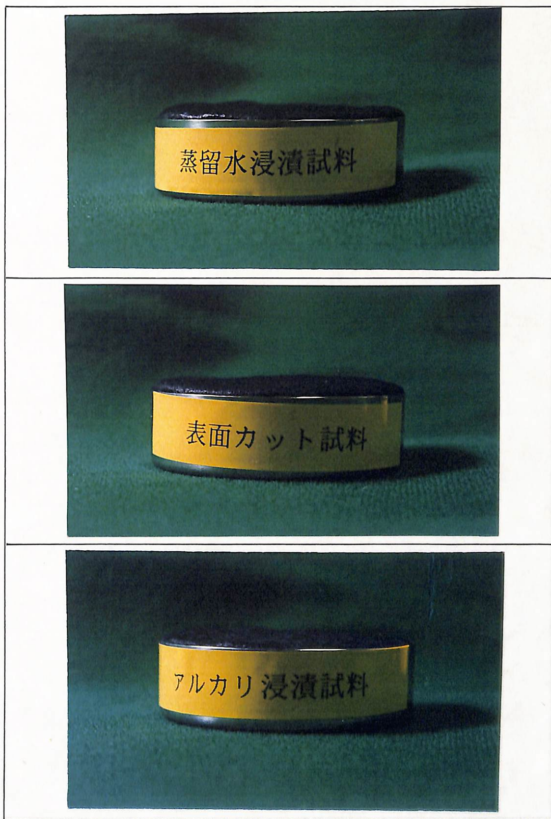
写真2.3.2 13週間浸漬試料側面外観
