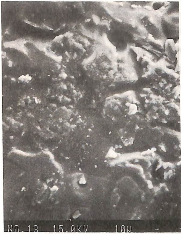
アスファルト固化体断面のSEM像
