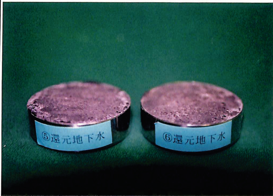
84日目還元環境下模擬地下水浸漬試料の外観 (⑤、⑥)
