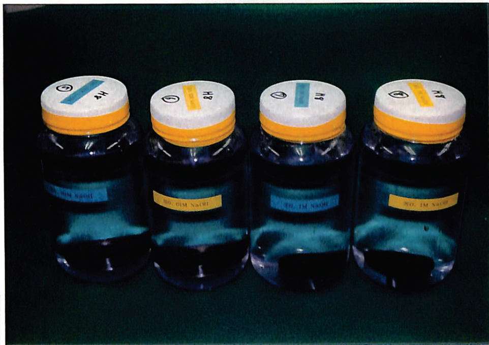
初期pH=12及びpH=13のNaOH溶液浸漬状況 (⑤、⑥、⑦、⑧)
