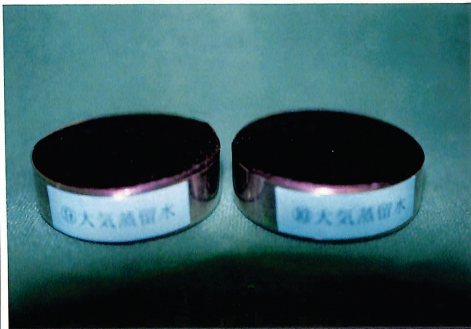
51日目大気下蒸留水浸漬試料の外観 (⑨、⑩)
