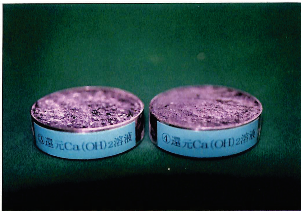
84日目還元環境下Ca(OH) 2 溶液浸漬試料の外観 (③、④)
