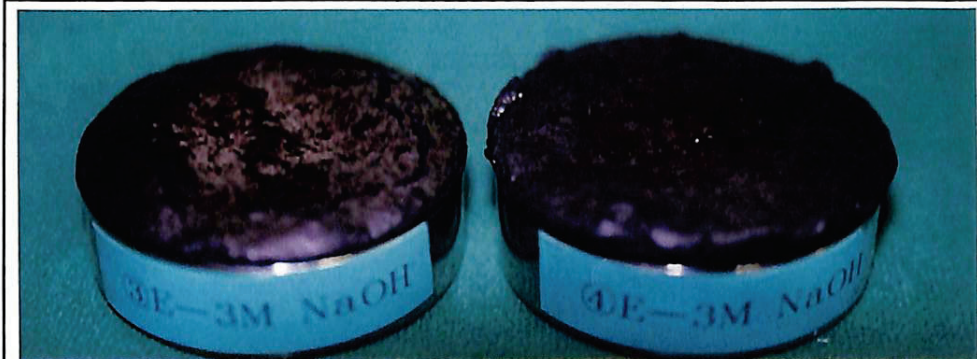
初期pH=11のNaOH溶液浸漬アスファルト固化体 (③、④)
