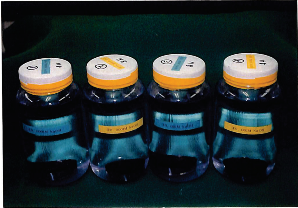
初期pH=10及びpH=11のNaOH溶液浸漬状況 (①、②、③、④)
