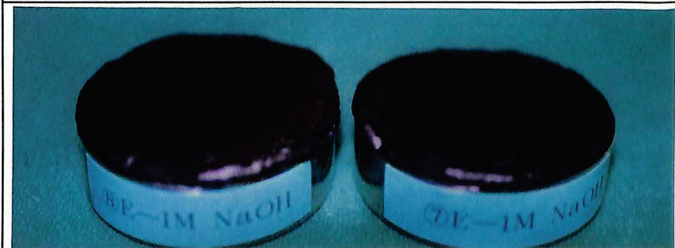
初期pH=13のNaOH溶液浸漬アスファルト固化体 (⑦、⑧)
