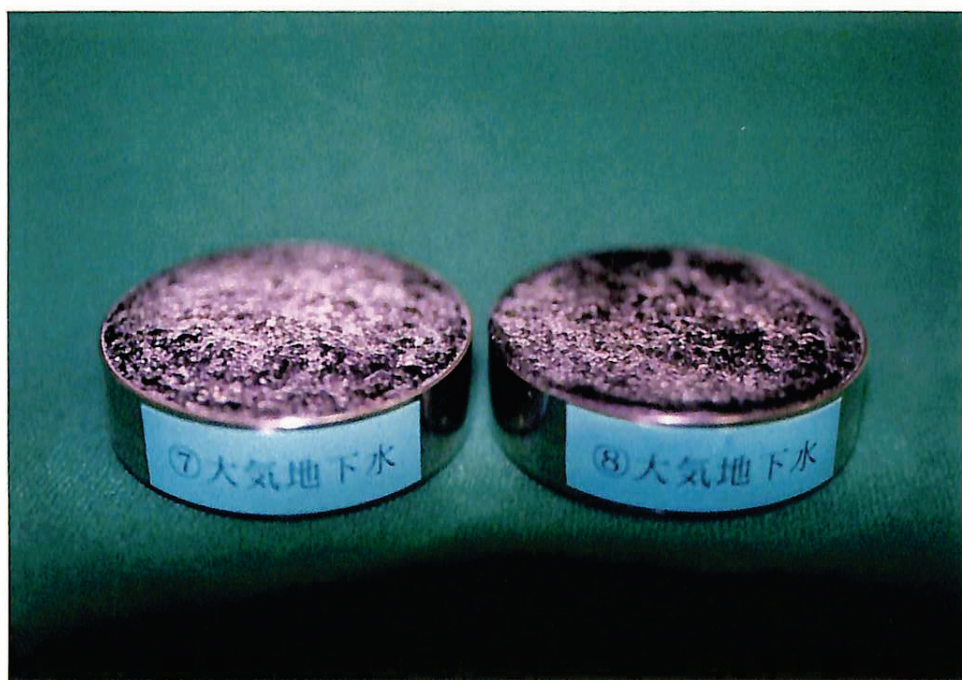
84日目大気下模擬地下水浸漬試料の外観 (⑦、⑧)
