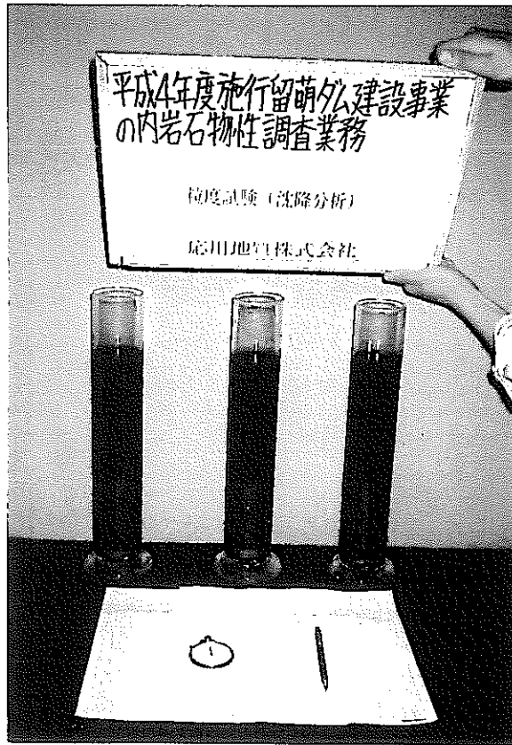
粒度試験（沈降分析）
