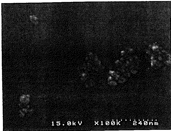
図3-3 サンプルA(Si濃度450ppm) 初期pH9.5溶液 限外ろ過フィルター表面SEM観察結果
