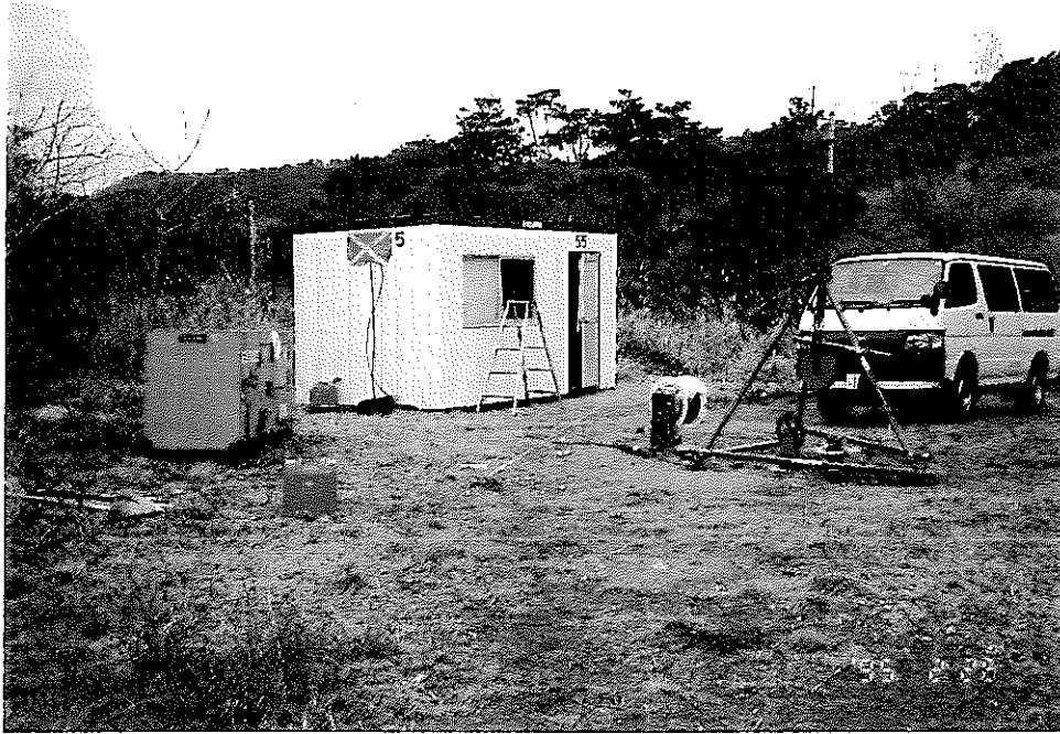
光ファイバ温度計測装置 による試錐孔内の温度 観測準備
