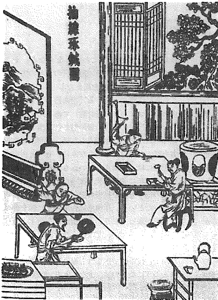
◀中国の書物『天工開物』（1637年）の挿絵。 4人の職人が針金を短く切って、羅針盤用の磁針を作っている。右端に大きな水瓶が見え、彼らが熱残留磁化を利用していたことがわかる。 資料/Joseph Needham, Science and Civilisation in China
