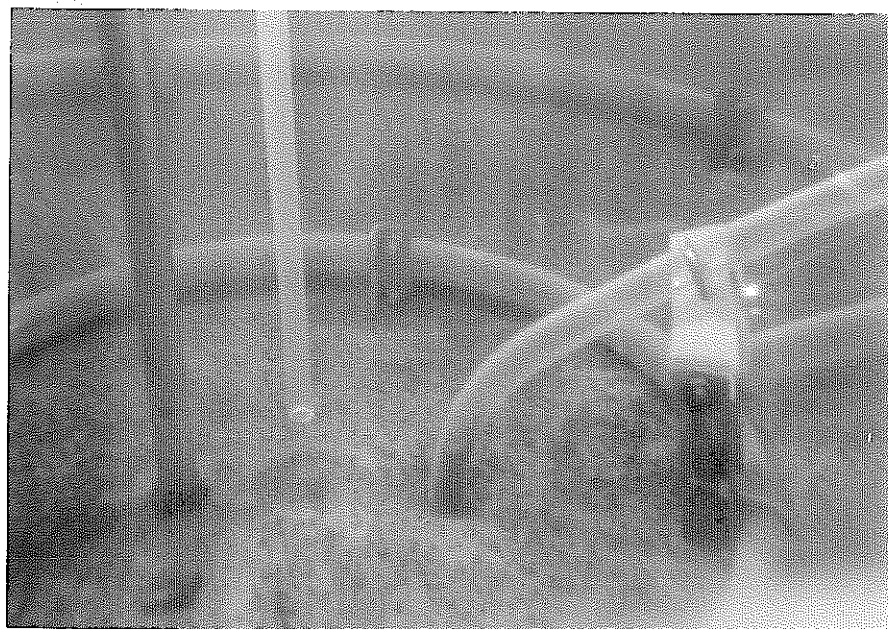
図3-21 スパージング試験終了時における252V13内吸い込み口の状態
