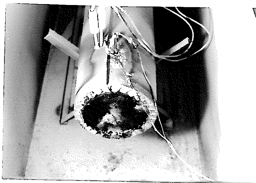
写真48. 試験番号6 配管下流端から漏れたナトリウムの燃焼跡
