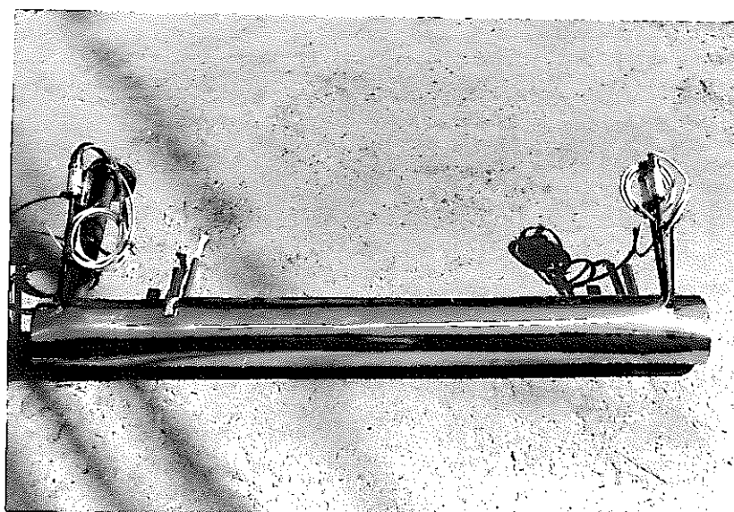
写真10 3B.1m長模擬配管 保温装着前
