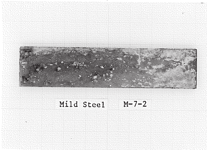
Photo 3—4(2) Mild Steel Test Sample after Descaling. スケール除去後の軟鋼平板試験体
