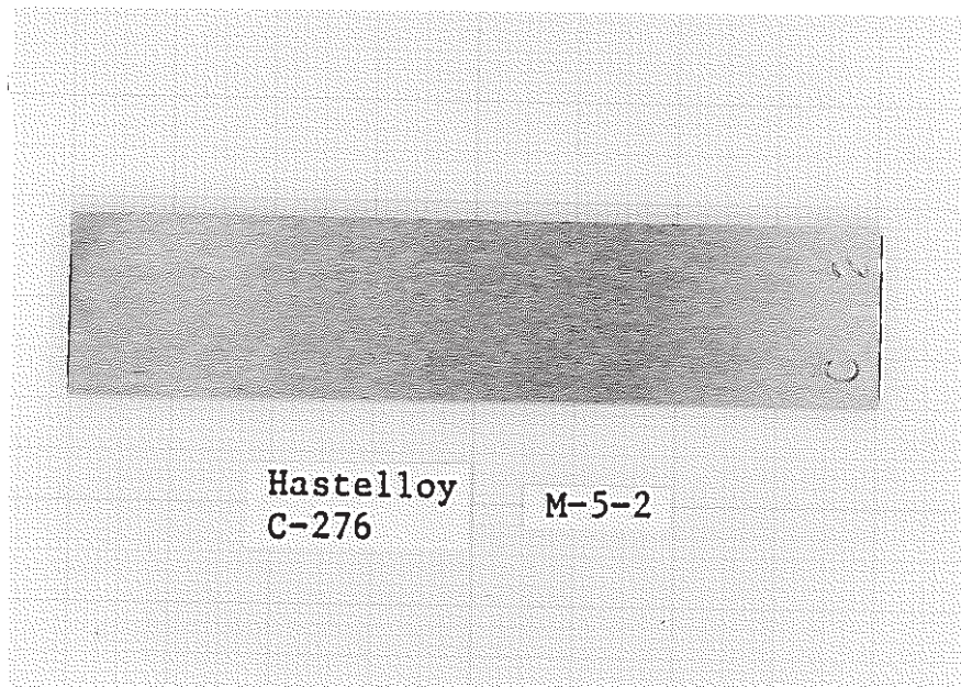
Photo 3—3 (2) Hastelloy C-276 Test Sample after Descaling. スケール除去後のハステロイC-276 平板試験体
