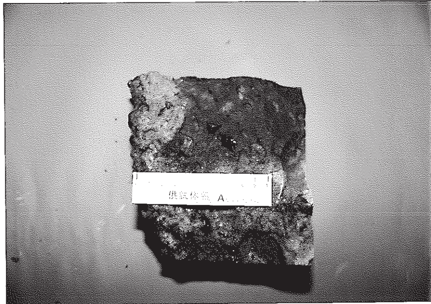
写真-23 フェノールフタレインおよびニトラミン溶液を噴霧した際の着色状態 (背面上部)
