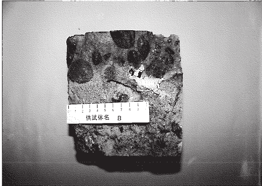
写真-25 フェノールフタレインおよびニトラミン溶液を噴霧した際の着色状態 (前面部)
