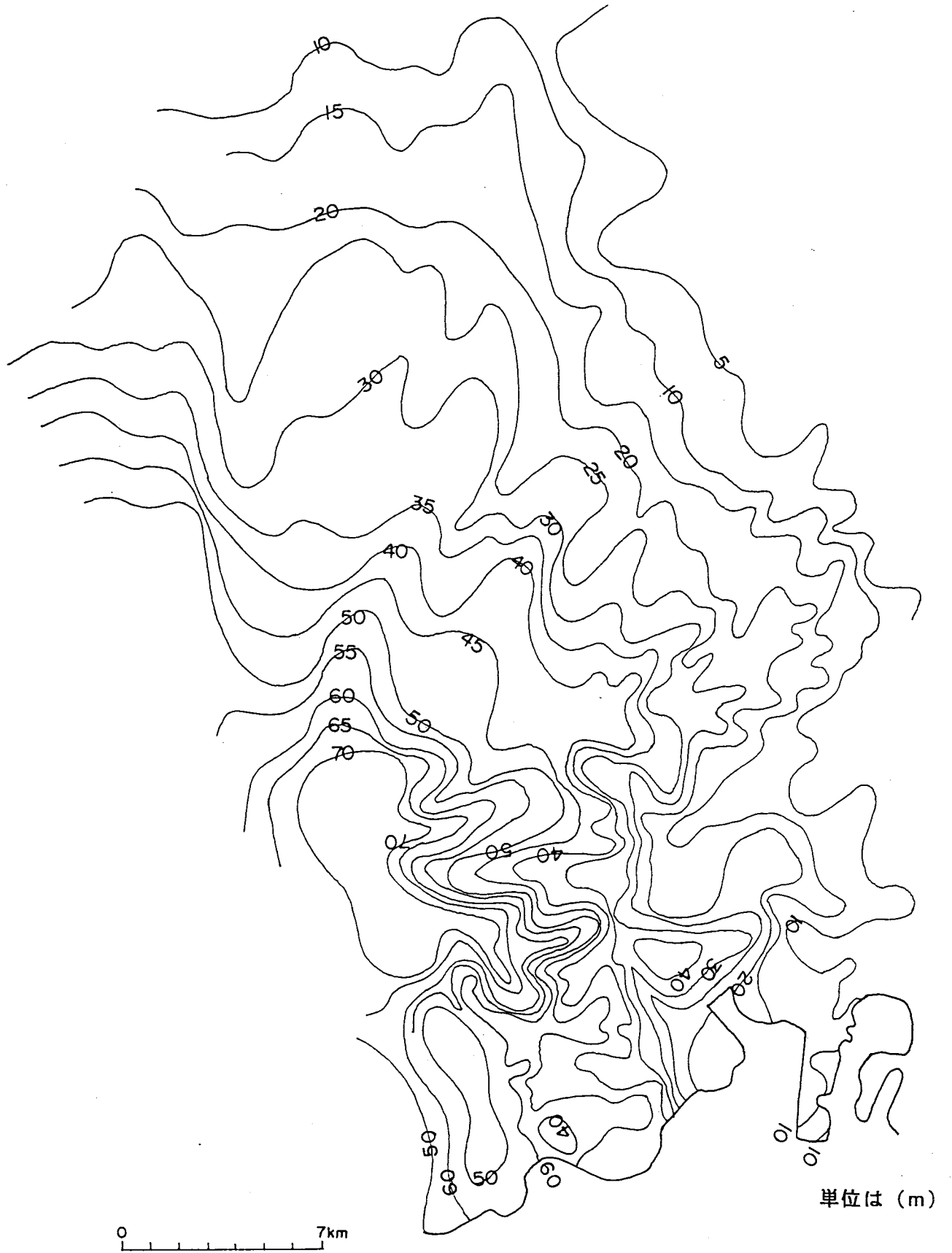
図5.2 冲積層基底面等深線図（濃尾平野）
