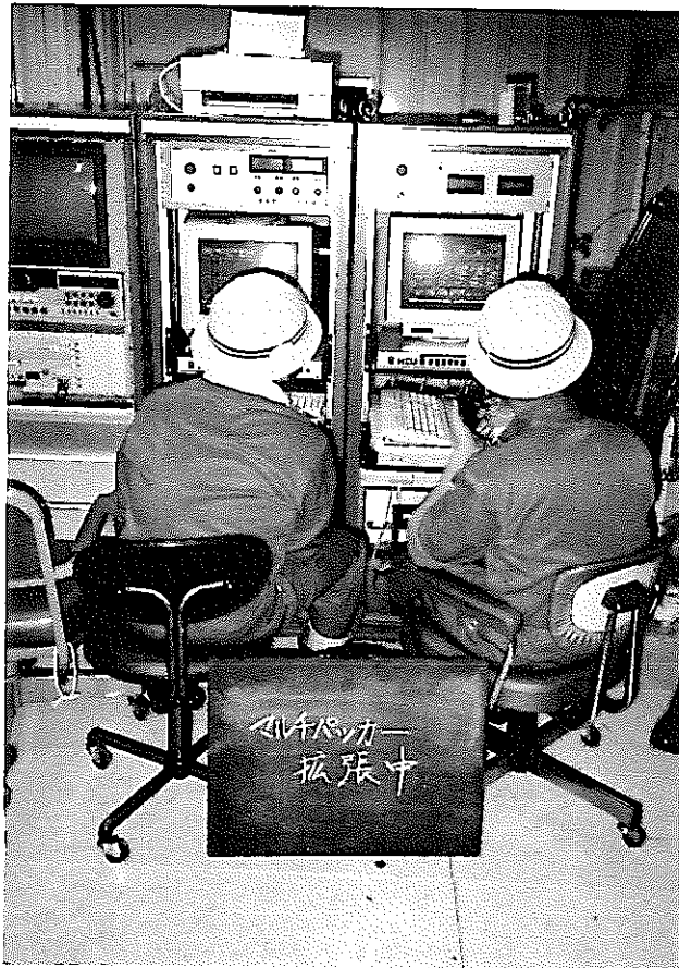
写真－５０ パッカー圧力監視状況
