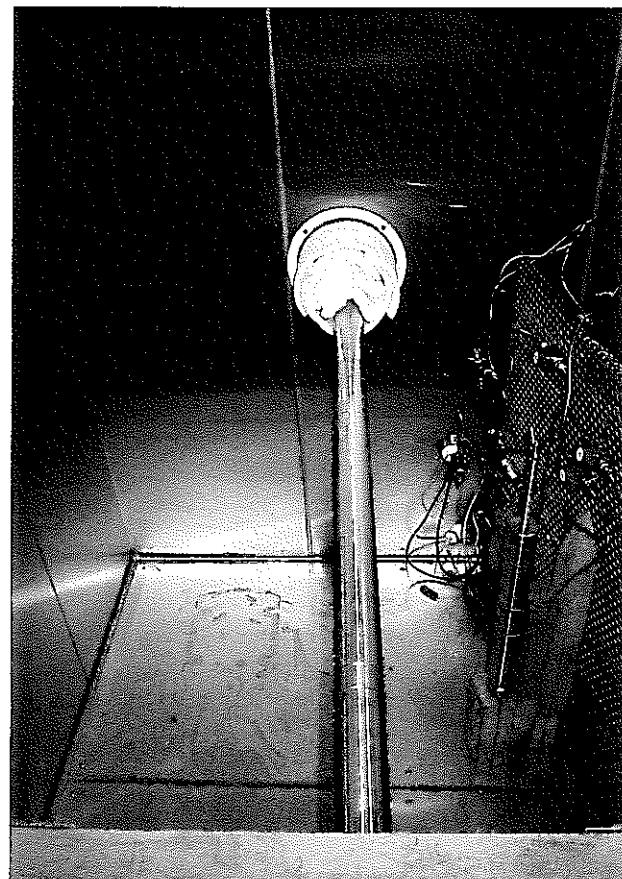
外部遮水パッカー耐温度試験状況
