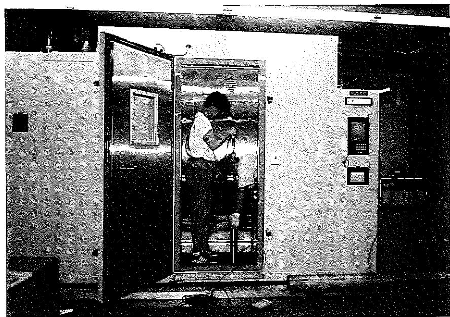
スライドポートパイプ（ダウンホールユニット）耐温度試験状況
