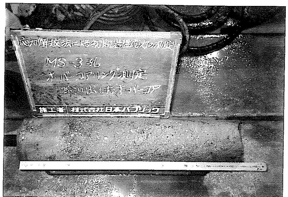
写真 23 回収したオーバーコア (MS-3孔)
