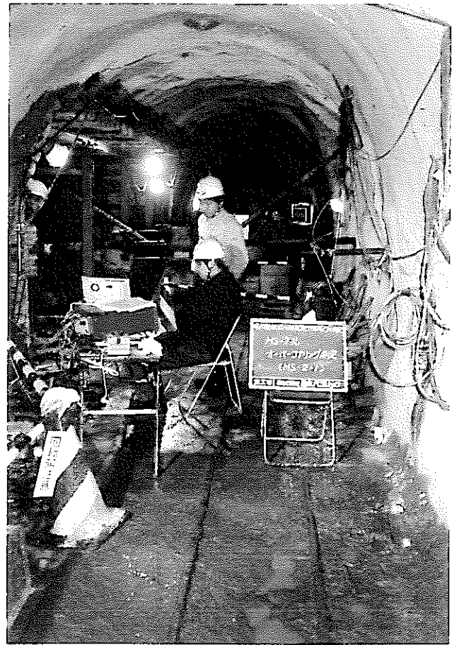
写真 19 オーバーコアリング測定状況 (MS-2孔)
