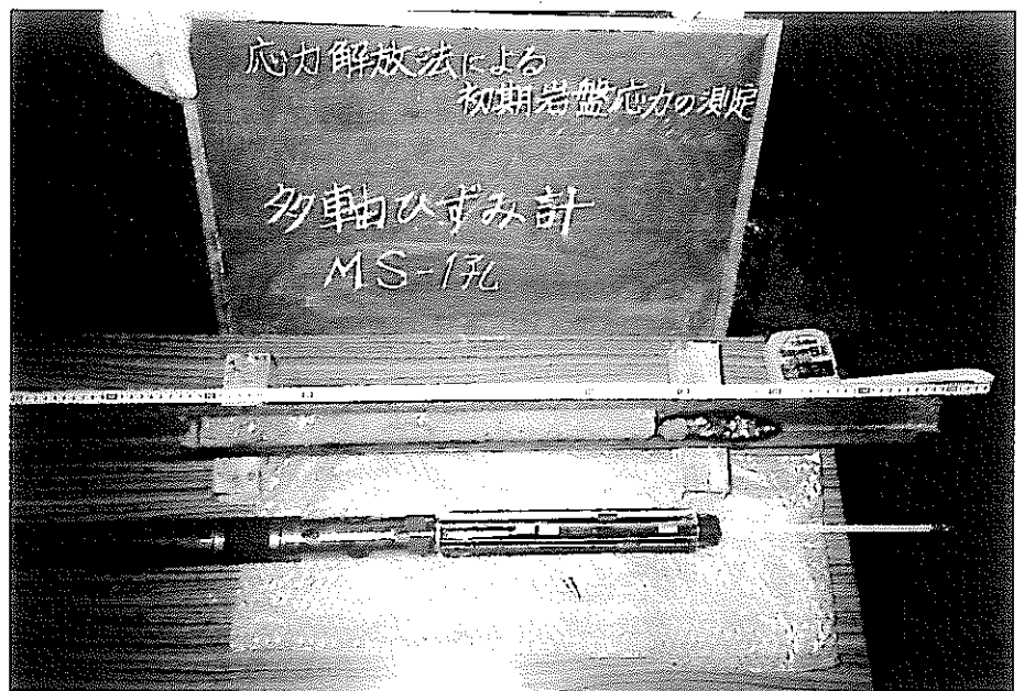
写真 10 センターリングコア と 8 成分ひずみ計 (MS-1孔)
