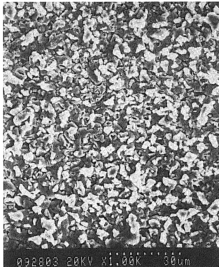
写真3-3 複合めっき表面のSEM観察結果 (基板、SUS316、試料No. 1)
