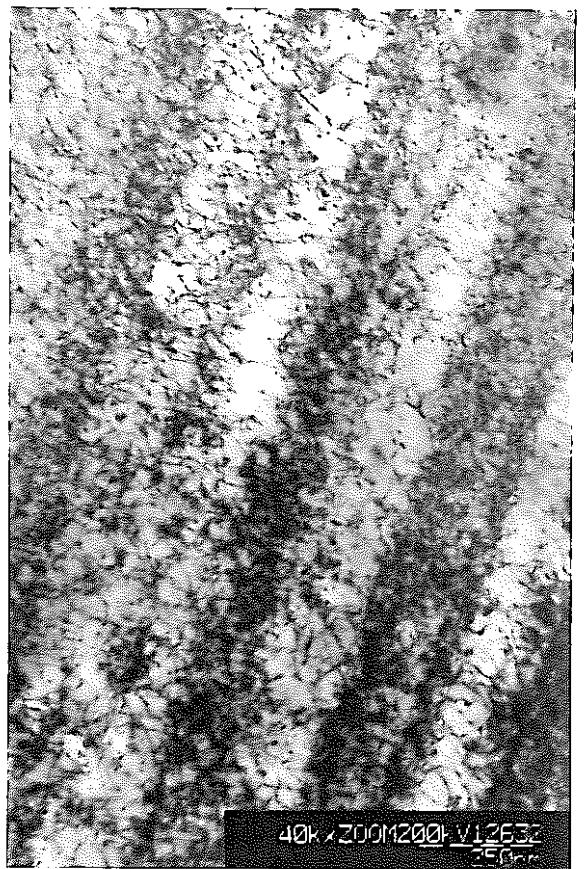
写真 8.1 F71 鋼 (1150 °C 押出) TEM 像
