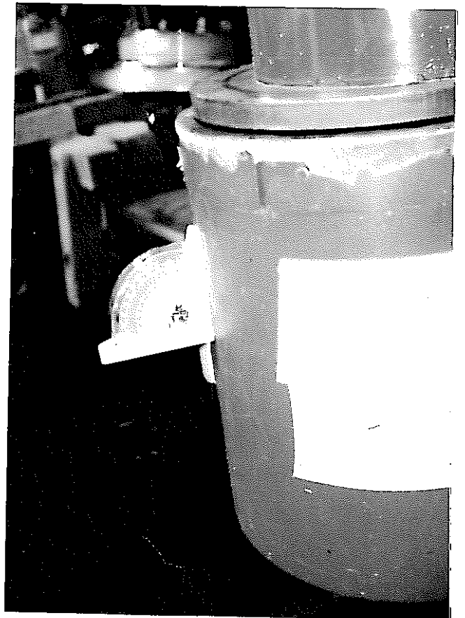
写真-6 LEP-25 傾き調整後 傾き3°
