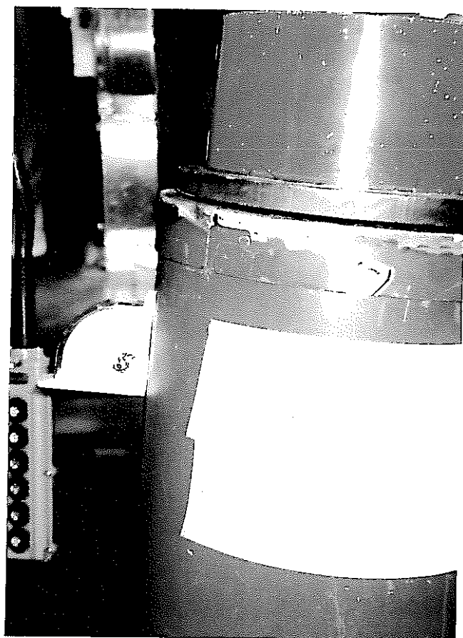
写真-3 LEP-25 S缶内側缶 傾き7°
