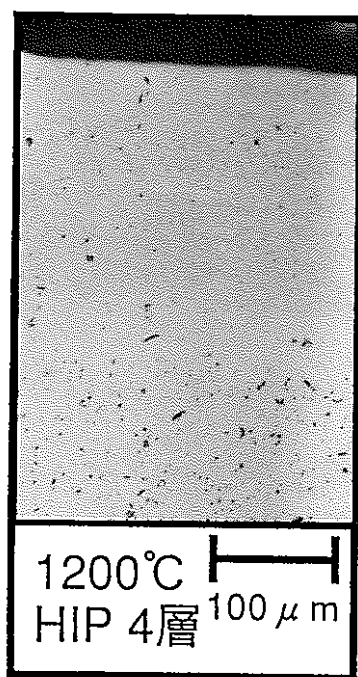
Fig.3-14 1200°C HIP 4層傾斜材の断面組織写真
