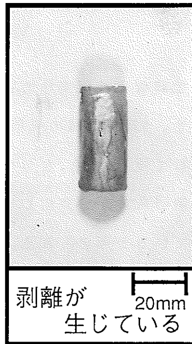
Fig.3-12 1200°C 常圧焼結4層材の外観写真
