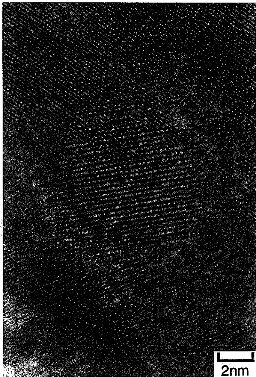
図9 被覆管中の \text{Y}_2\text{O}_3 粒子と母相の界面構造の高分解能観察
