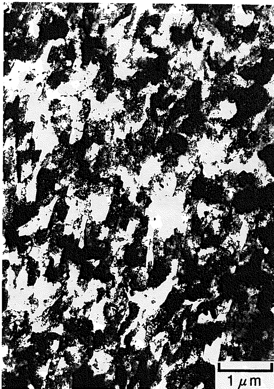
図29 破断面近傍の組織写真
