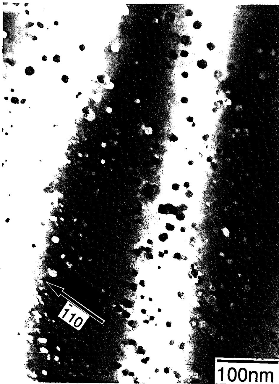
図6  $\vec{g}=\langle\bar{1}10\rangle$  2波励起状態で観察した分散粒子
