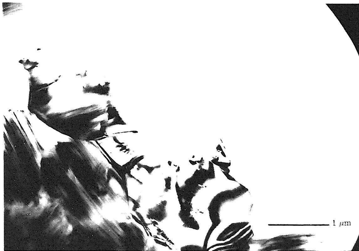
図26 SiCの未照射材の電子顕微鏡写真
