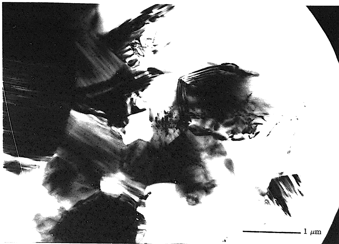
図25 SiCの未照射材の電子顕微鏡写真
