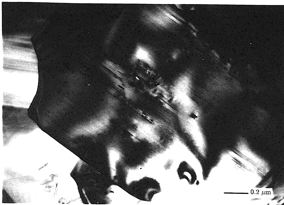
図27 SiCの未照射材の電子顕微鏡写真
