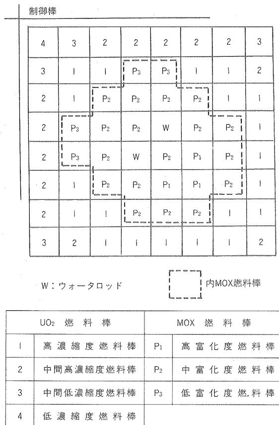
図3 MOX燃料集合体の燃料棒配置図
