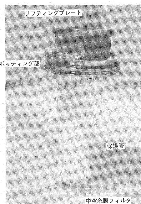
写真1 中空糸膜フィルタモジュールの外観
