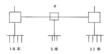
最近の設計では3系統のCRを持っており、信頼性が上昇した。但し、Common mode failure は考えていない。又、Pump の mechanical enertia は50 sec もあり、Pony moter をつなぐと boiling は起きない。
