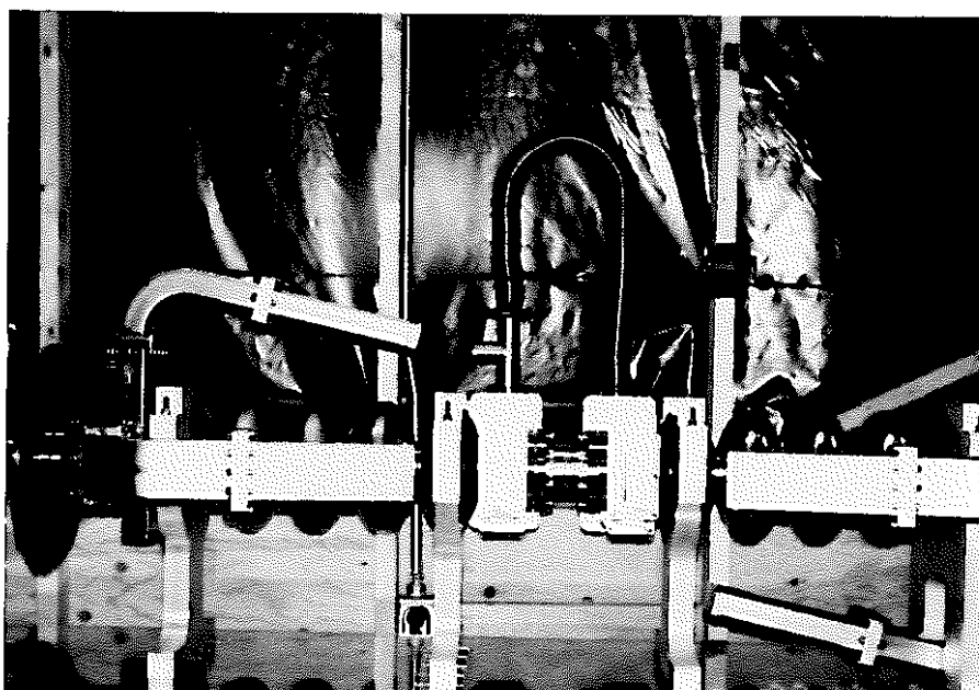
㉒ CEBAF超電導キャビティ 5セルから成る超電導キャビティ(蛇ばら状に黒く見える)2個が接続されている。
