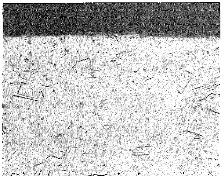
写真6 ナトリウム流動試験前の被覆管の顕微鏡組織 (S53)
