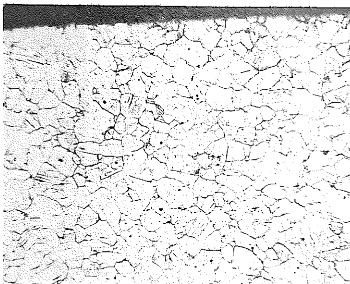
写真1-0 円状に黒カッ色となった被覆管の顕微鏡組織 (S72)
