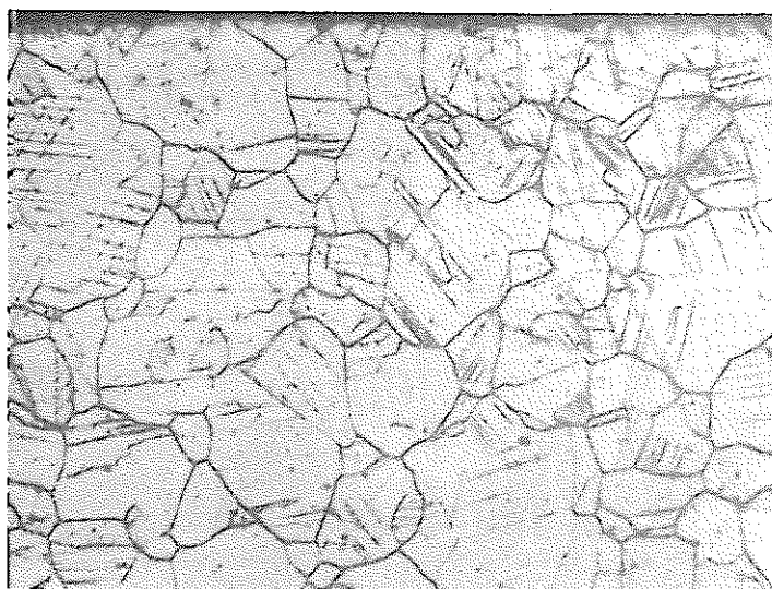
写真12 金属光沢を呈する部分の顕微鏡組織 (S79)
