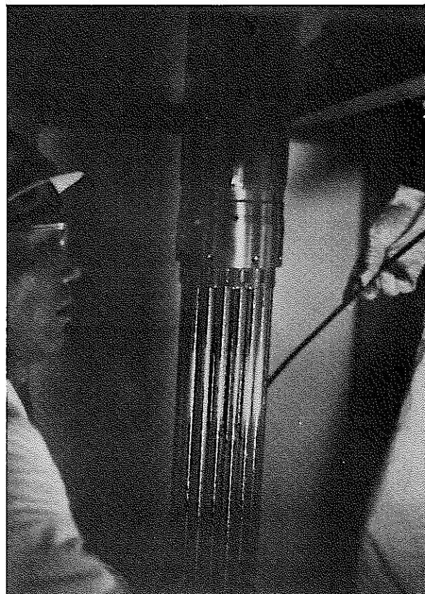
写真 5.6.1 シュラウド・チューブ挿入試験
