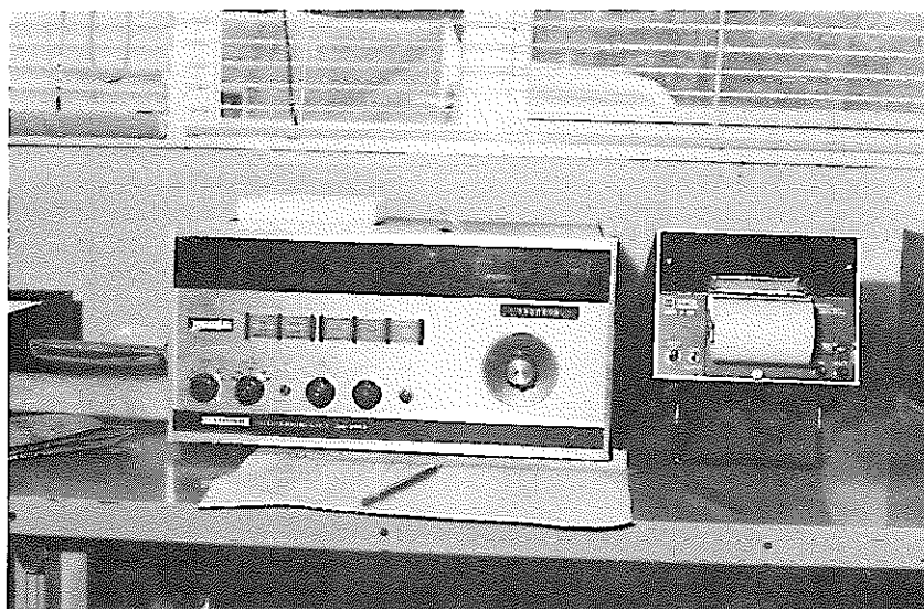
Fig. 2.5 熱ルミネセンス線量計の線量読み取り装置の外観図
