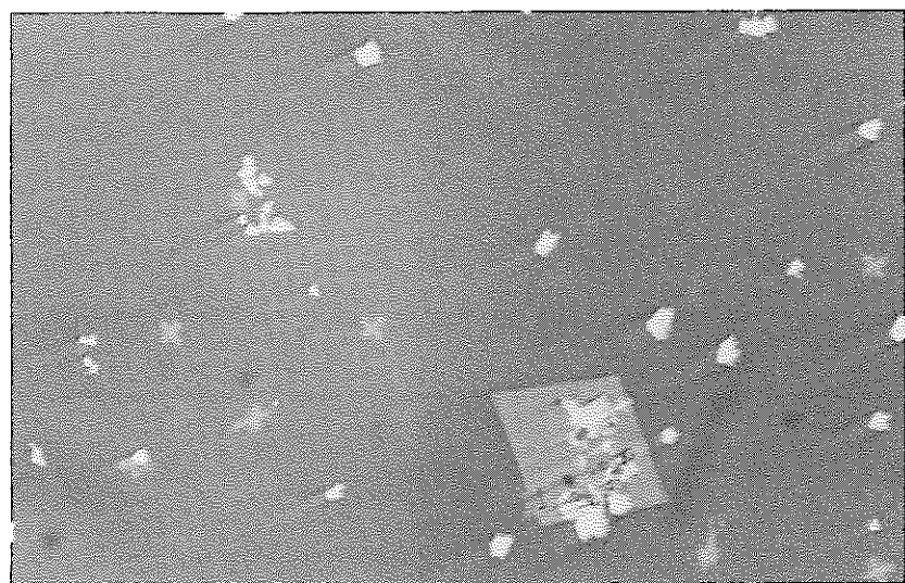
写真-14 失透化したP 4004 (2 wt% \text{UO}_3 )の光学顕微鏡写真(700 °C - 18日)
