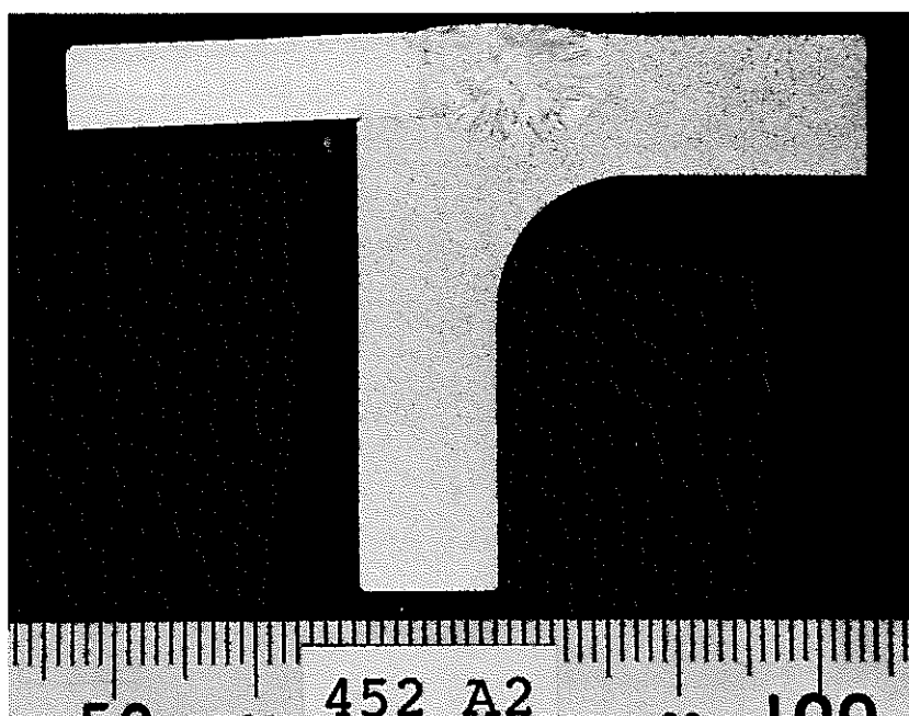
写真-3-3 (7/10) 再溶接後の溶接断面マクロ観察 (×1.5)
