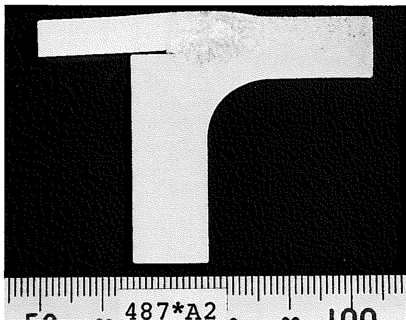
写真-3-3 (8/10) 再溶接後の溶接断面マクロ観察 (×1.5)
