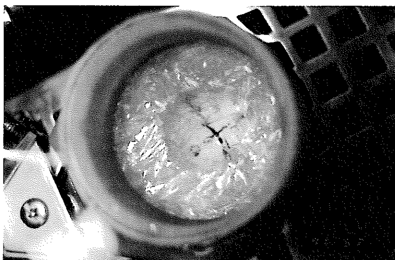
写真-4.1 冷却温度 -15^{\circ}\text{C} での30%TBP-nドデカン系溶媒の晶析状態
