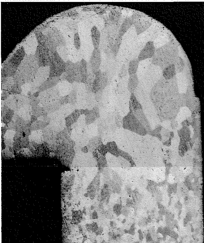
図15 試料未封入溶接部健全性試験Wカプセルの金相断面写真(加熱前)
