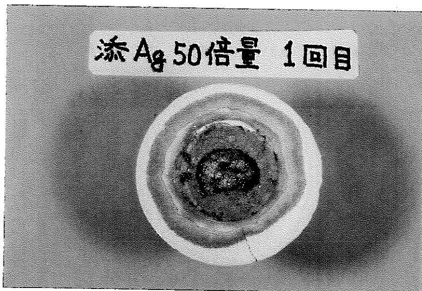
写真8 鉛抽出試験により生成した鉛ボタンの灰吹後の貴金属ビード (1) (銀添加量：ロジウムの50倍量)
