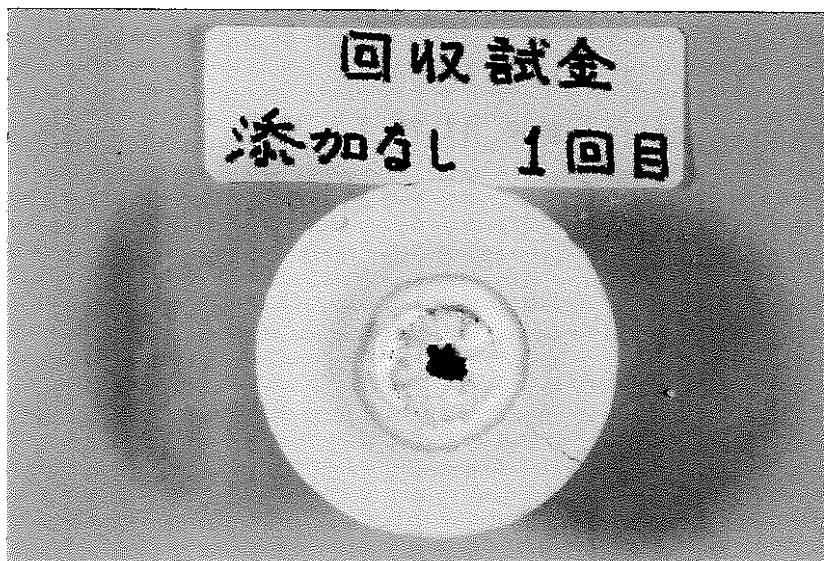
写真15 回収試金法により生成した鉛ボタンの灰吹後の貴金属ビード (貴金属無添加)
