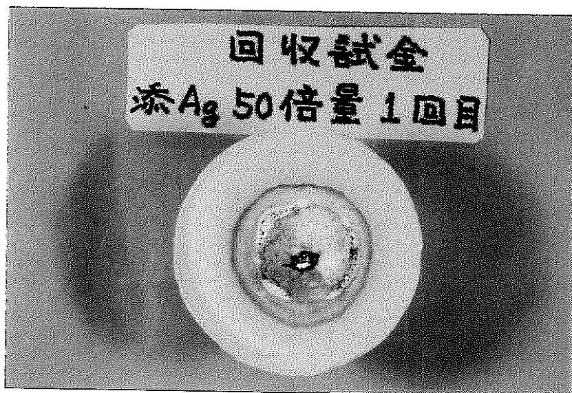
写真16 回収試金法により生成した鉛ボタンの灰吹後の貴金属ビード (銀添加量：ロジウムの50倍量)
