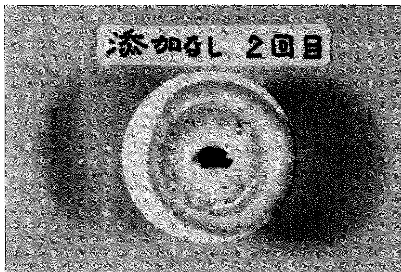
写真11 鉛抽出試験により生成した鉛ボタンの灰吹後の貴金属ビード (2) (貴金属無添加)
