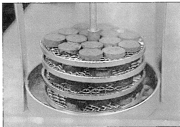
写真1  $\text{UO}_2/\text{黒鉛}$ 混合粉の仮成型タブレット（還元前）
